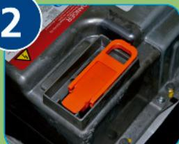
2 Desconectar de la batería de alto voltaje la conexión de seguridad naranja y guárdela en un lugar seguro. Dejar en el sitio una etiqueta de advertencia.
