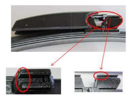
Al no hacer el acoplamiento total de la escobilla sobre el brazo, lo que ocurre es que la escobilla no ejerce la misma presión sobre el parabrisas, lo cual produce un desgaste irregular de la goma y una limpieza deficiente del cristal.
