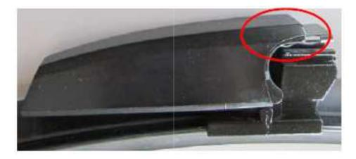
Al montar la escobilla a presión, en vez de deslizarlo sobre el adaptador, lo que ocurre es que la presión que va aplicar la escobilla sobre la luna no va a ser la que debe por lo tanto va a producir un desgaste irregular y prematuro de la misma.
