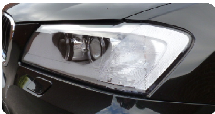
Faro con condensación
